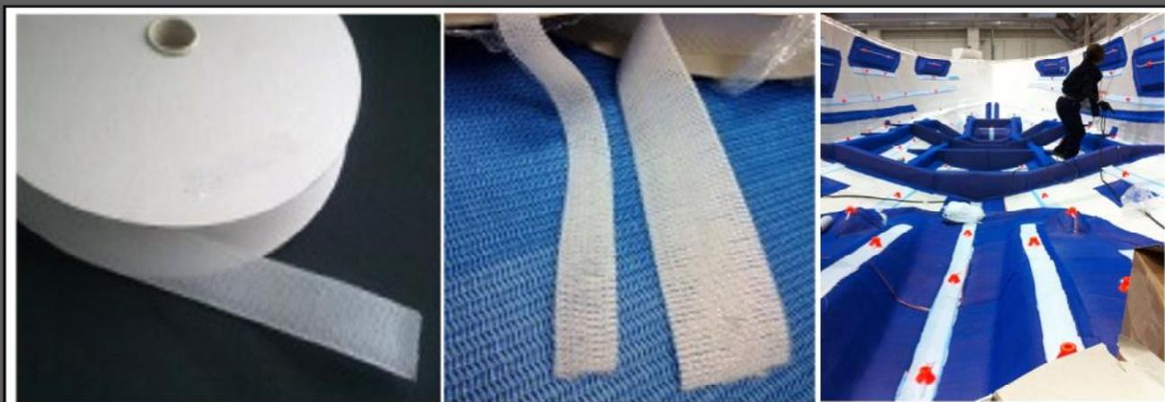
Diffusore di flusso di aria e resina, consente il trasporto della resina e dell'aria nei processi di infusione con il metodo del sottovuoto. Composto da una maglia tridimensionale in Polietilene 100%, offre una distribuzione della resina in entrata omogenea e continua, senza "marcare" la superficie del manufatto.
